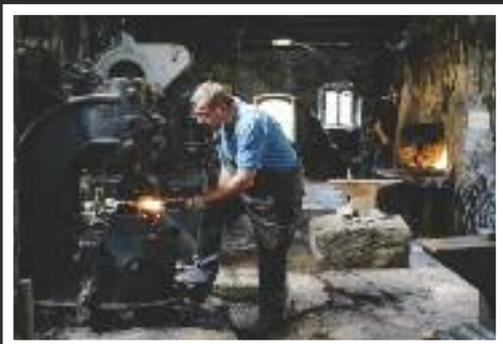
**Schritt für Schritt.** Nach dem Vorschmieden wird der Stahl in einer Warmkreissäge in die benötigte Länge geschnitten, anschließend weiter bearbeitet und in Form gebracht.
